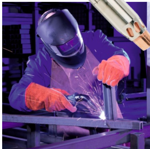
Uchwyt RAB GRIP włączony układ odciągania dymów spawalniczych
